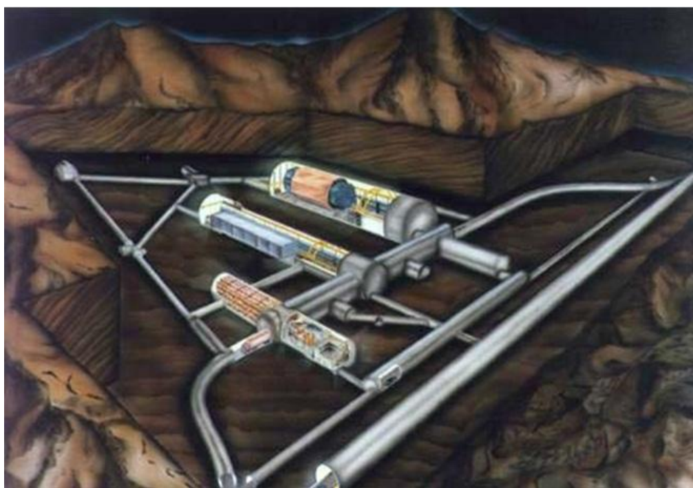
图 2 大沙索山实验室示意图。它由三个实验室山洞和隧道组成。隧道可通汽车。
